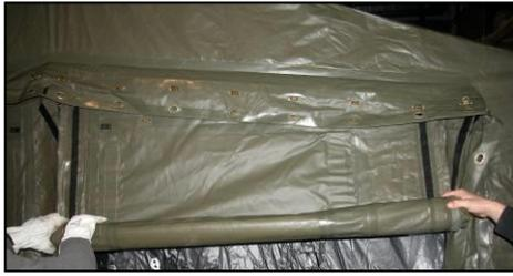
Rouler les portes jusqu'en haut et accrocher les sangles de maintien sur les crochets fixée sur la toile au dessus des portes.
