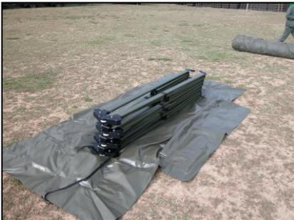
Ouvrir le sac de la charpente et celui des pieds puis positionner quatre pieds de chaque côté de la charpente à une distance d'environ trois mètres
