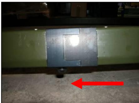
Débloquer le mécanisme des bras extérieurs en effectuant un **mouvement de translation au bouton** et replier légèrement le bras
