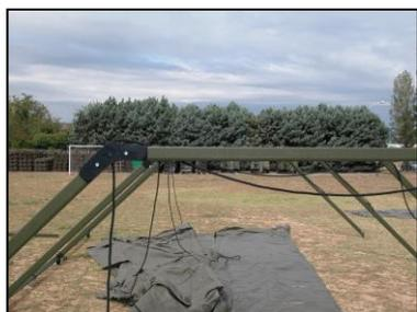
Faire passer les cordes de faitage le long de la poulie et les cordes intermédiaires à travers l'anneau prévu à cet effet et les amener au bout de la charpente en passant par dessus jusqu'au taquet coinçant. Laissez dépasser la corde du taquet de 10 cm.
