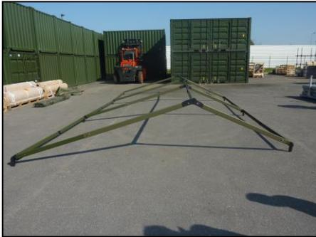
De chaque côté de l'armature, retirer la goupille et l'axe, rentrer la partie télescopique et repositionner l'axe et la goupille.
